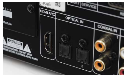
W sekcji cyfrowej nie pojawia się USB, za to jest HDMI (z kanałem ARC).
